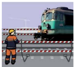
Rys. 4 Wygradzenie czynnych torów kolejowych przy obiektach inżynierskich
