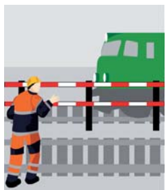
Rys. 3 Wygradzenie czynnego toru kolejowego
