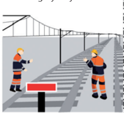
Rys. 2 Wyłączenie i oznakowanie toru kolejowego
