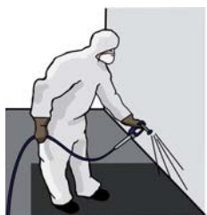
Rys. 4 Prace malarskie – ochrona dróg oddechowych
