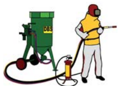
Rys. 2 Piaskowacz – wyposażenie ochronne
