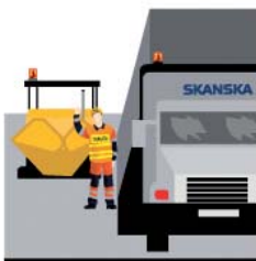
Rys. 4 Wyznaczenie osoby koordynującej przy manewrze cofania pojazdu
