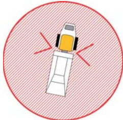
Rys. 6 Strefa zagrożenia pracy wozidła
