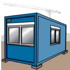
Rys. 5 Usytuowanie kontenera na bloczkach betonowych
