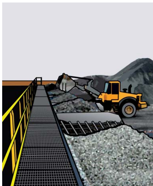
Rys. 4 Zabezpieczenie zbiorników zasypowych
