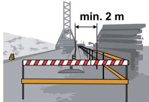
Rys. 7 Wygradzanie torowiska żurawi szynowych
