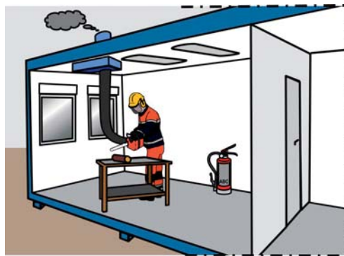
Rys. 3 Instalacja wyciągowa dla narzędzi spalinowych stosowanych wewnątrz pomieszczeń zamkniętych
