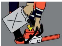
Rys. 2 Prawidłowy sposób uzupełniania paliwa w narzędziach spalinowych
