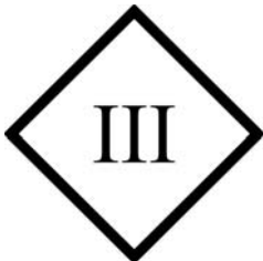
Rys. 6 Symbol urządzenia zasilanego napięciem bezpiecznym
