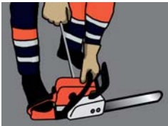
Rys. 2 Prawidłowy sposób pracy z pilarką łańcuchową - uruchomienie
