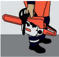
Rys. 1 Prawidłowy sposób pracy z pilarką łańcuchową - transport
