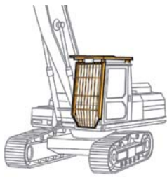
Rys. 2 Konstrukcja zabezpieczająca przed spadającymi przedmiotami
